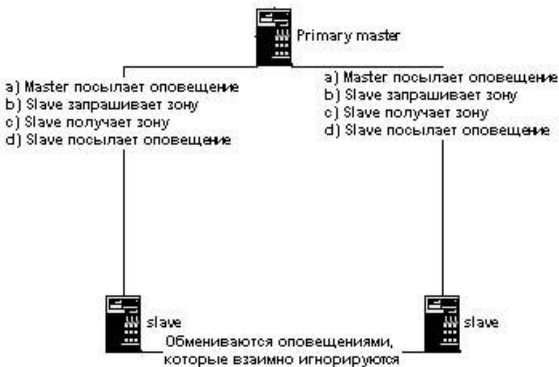
Рис.2. Схема работы DNS NOTIFY
