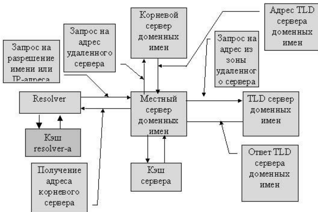
Рис.3. Схема разрешения запросов с кэшированием ответов.
