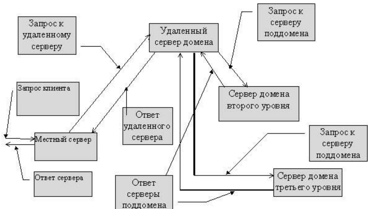
Рис. 5. Рекурсивная (для местного сервера) и нерекурсивная (для удаленного сервера) процедуры разрешения адреса по IP-имени.
