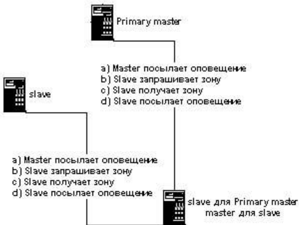
Рис.3. Схема работы DNS NOTIFY при двухзвенном оповещении об изменении описания зоны.
