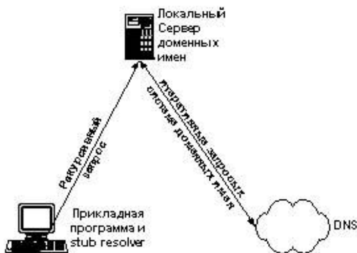
Рис.1. Типовая схема взаимодействия Resolver с локальным сервером доменных имен.
