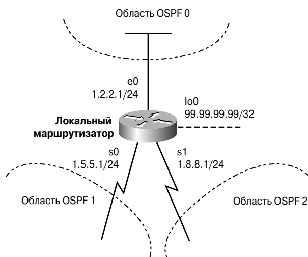
Рис. 6.5. Схема сети для примера применения протокола OSPF
